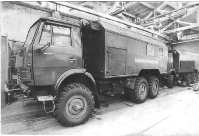
Рис. 2. Подвижная патологоанатомическая лаборатория ПАЛ-01, опытный образец в сборочном цехе.
